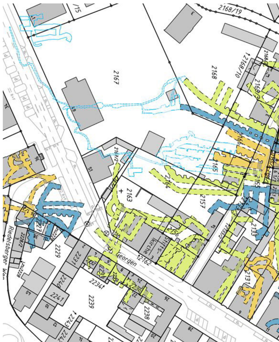
Abb. 7: Der südliche Ausläufer des Sterns von St. Georgen mit den bisher er- forschten weiteren Kelleranlagen und den Explorationsstollen bzw. Wasserseigen wurde in den bestehenden Katasterplan eingetragen (Katasterkarte thematisch ergänzt durch Vermessungsamt Stadt Bay- reuth, Vorgaben: Bernhard Häck, BLFD).
